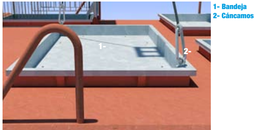
Tapa trafo y materiales
