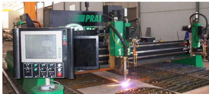
Corte con plasma de alta definición
