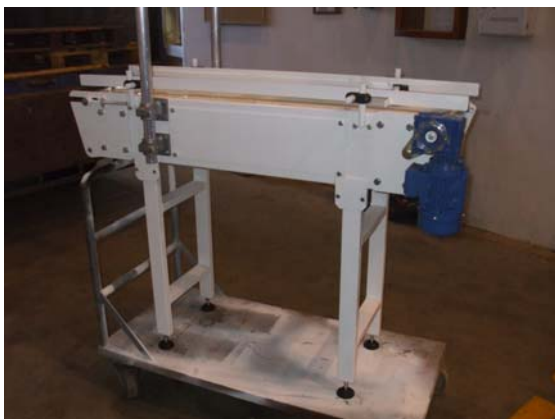
Construcción de cinta transportadora.
