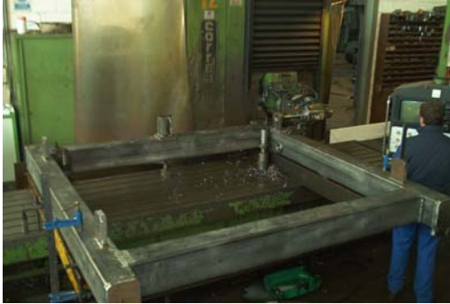
Mecanizado gran estructura.
