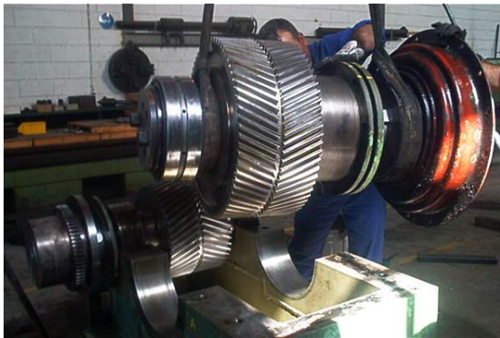
Mecanizado y Ajuste de reductor.
