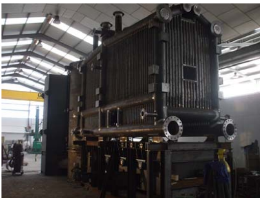
Caldera de vapor
