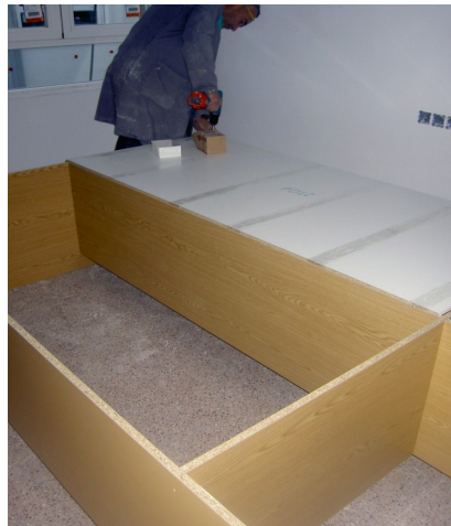
El siguiente paso es colocar la trasera del armario, en plastificado de 10mm.
