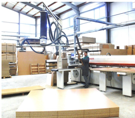
Seccionadora de tableros.
