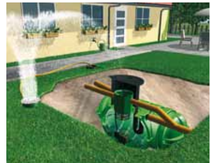
Roth Rain 3500 PLUS para riego de jardines compuesto de ROTHAGUA® Twinbloc® 5000, filtro horizontal, grupo de presión sumergido, kit aspiración, accesorio antirremolino y equipo automático de entrada de aguas de red.
